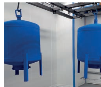
Piezas en cabina de pintura.
