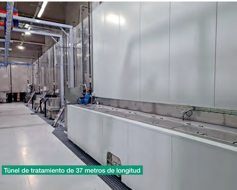
Horno de secado de humedad previo a la aplicación de pintura
