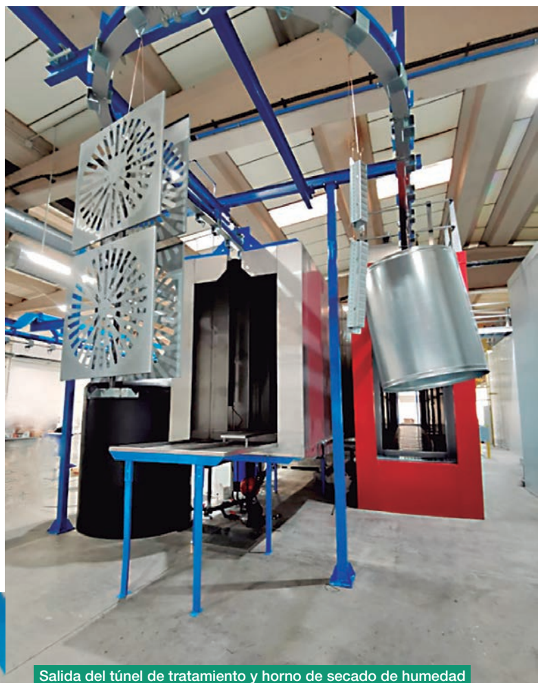
Salida del túnel de tratamiento y horno de secado de humedad
